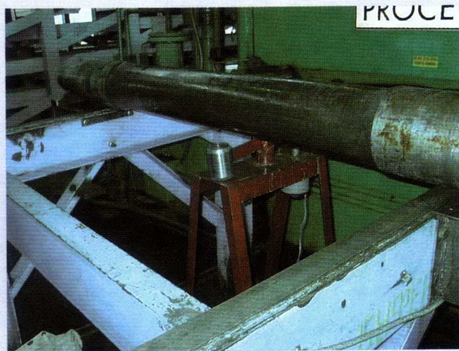
Рис. 2. Рабочее место для контроля вагонных осей методом нелинейной акустики
